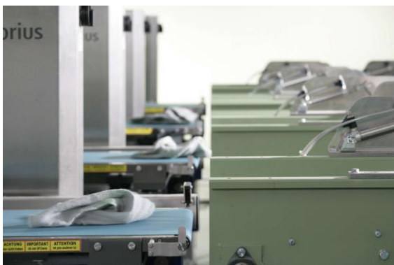
La inspección automatizada complementa la inspección visual de los paños de limpieza (Foto: MEWA)
